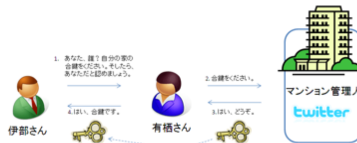
図4 OpenID Connectのクレーム集約、分散クレーム
